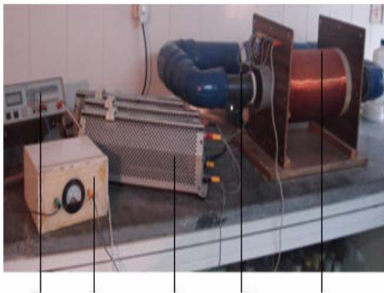
شکل شماره ۱- دستگاه انکوباسیون جنین جوجه و مولد میدان الکترومغناطیس با فرکانس کم (۱) سیم پیچ مولد میدان (۲) سیستم انکوباسیون (۳) رئوستا (۴) خازن (۵) آمپر متر
