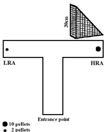
شکل شماره ۱- تصویر شماتیک T-Maze. این وسیله از سه بازو شامل بازوی ورود، بازوی پاداش بیشتر و بازوی پاداش کمتر تشکیل شده است. همچنین دارای سه سکو به شکل مثلث قائم الزاویه در سه سایز می‌باشد. حیوانات می‌توانند هر کدام از بازوهای پاداش کمتر یا پاداش بیشتر را انتخاب کنند و می‌توانند از سکو بالا رفته و به پاداش بیشتر برستند. LRA بازوی پاداش بیشتر. HRA بازوی پاداش کمتر.
