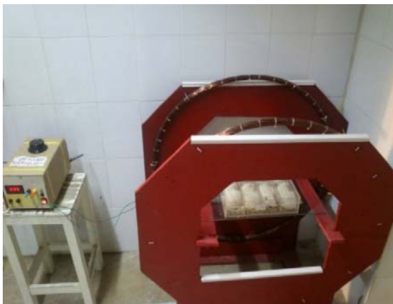
شکل شماره ۱- دستگاه شبیه ساز میدان الکترومغناطیسی کم فرکانس تلفن همراه و موقعیت قرارگیری حیوانات
