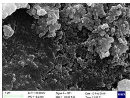
شکل شماره ۴- میکروگراف الکترونی روبشی از نانوذرات نقره سنتز شده به روش سبز
