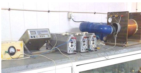
تصویر شماره ۱- سیستم مولد میدان الکترومغناطیس و انکوباسیون (A) سیم پیچ مولد میدان الکترومغناطیس، (B) سیستم انکوباسیون، (C) رئوستا، (D) ولت سنج، (E) خازن
